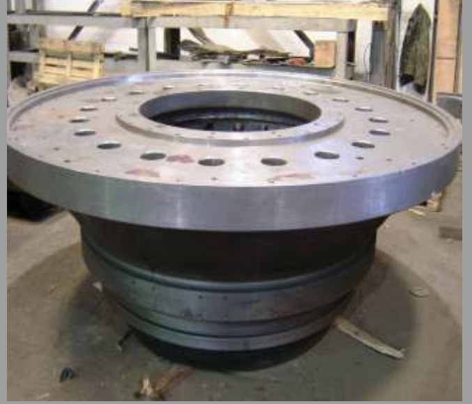
Dik Değirmen Alt Tablası (GGG, 23 Ton) / Vertical Mill Grinding Table (Ductile Iron, 23 Tons)
