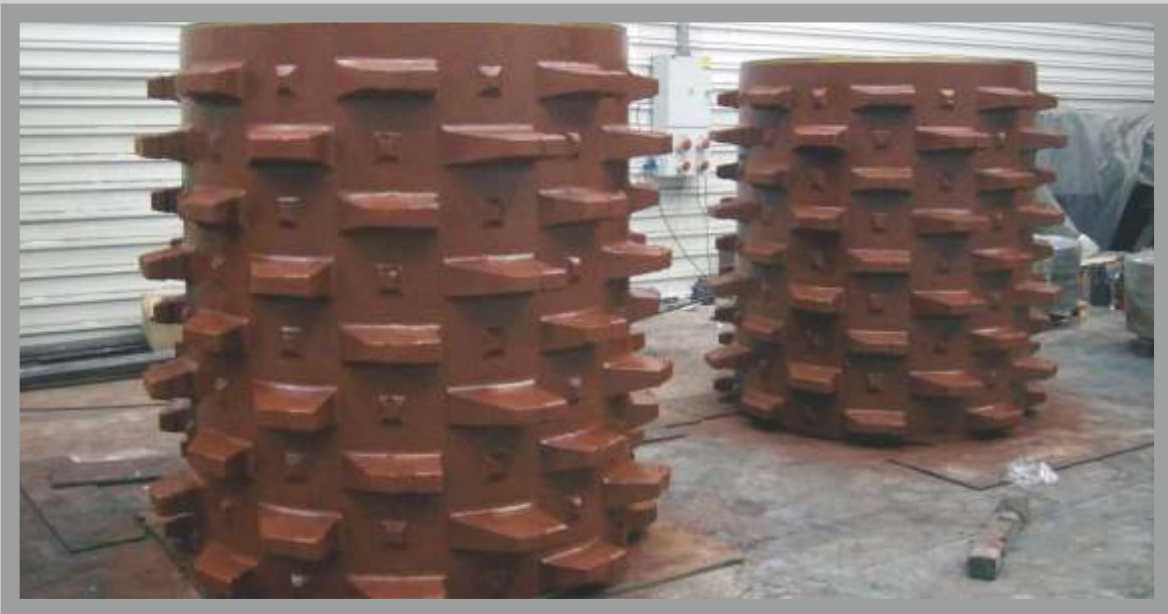
Çift Tanburlu Kırıcı Gövdesi (Mn) / Double Roll Crusher Shell (Hi-Mn)
