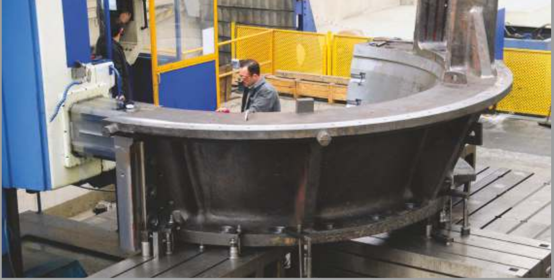
Kırıcı Üst Gövdesi (42 Ton) / Gyratory Crusher Split Top Shell (42 Tons)
