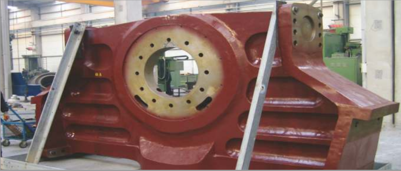
Dik Değirmen Tablası Vals Taşıyıcısı (18 Ton) / Vertical Grinding Mill Roller Carrier (18 Tons)
